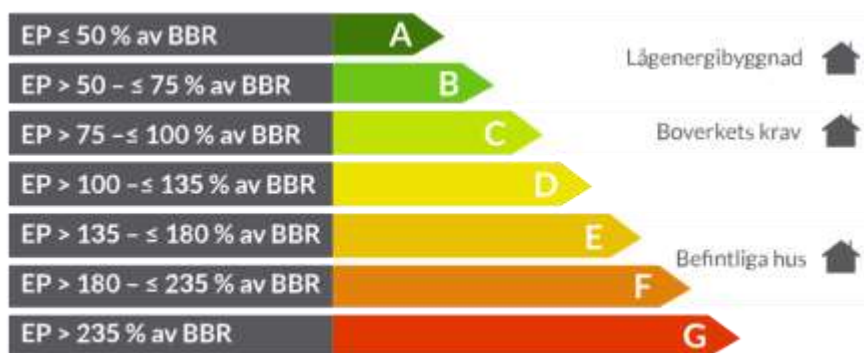
Figur 1: Nuvarande energiklassning, där C motsvarar krav på energiprestanda enligt nuvarande byggnorm (Boverkets Byggregler).
